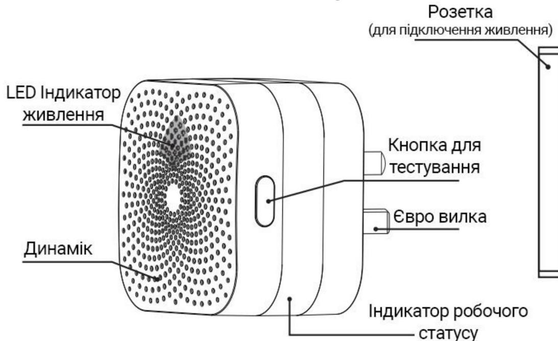
Побутовий детектор газу Hanwei Airradio I1 – є інтелектуальним пристроєм для моніторингу концентрації природного газу в приміщенні та здатний вимірювати рівень в межах 0~100% LEL. Датчик подає звуковий сигнал тривоги та вмикає світловий червоний індикатор при перевищенні безпечною рівня концентрації газу (7% LEL). В приладі є механізм самотестування, при несправності або виході з ладу він подасть сигнал.
