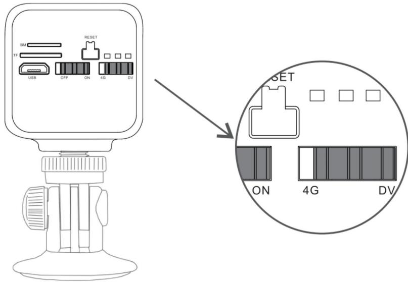
Для включения камеры переведите кнопку питания в положение «ON». Кнопку выбора режима переведите в положение DV. Установите карту памяти MicroSD в слот. DV режим требуется для постоянной записи и хранения файлов на карте памяти. Чтобы просмотреть материал с носителя, нужно перейти в 4G режим и в приложении открыть пункт «TF карта», где доступны все видео. Можно извлечь внешний носитель и подключить его к компьютеру отдельно от камеры и просмотреть файлы на ПК.
