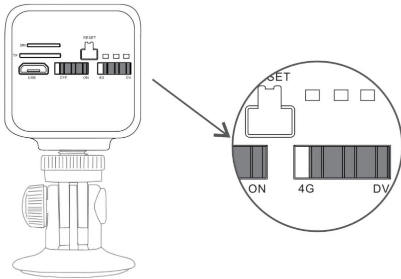
Переведіть кнопку живлення в положення «ON» для увімкнення камери. Кнопку вибору режиму переведіть в положення «DV». Встановіть у слот карту пам'яті MicroSD. DV режим потрібен для постійного запису та зберігання файлів на карті пам'яті. Щоб переглянути матеріал з носія, потрібно перейти в 4G режим та в додатку відкрити пункт «TF карта» де доступні усі відео. Також можна вийняти зовнішній носій та підключити його до комп'ютера окремо від камери та переглянути файли на ПК.
