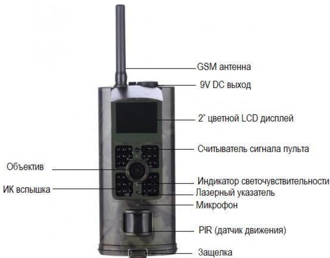
Рис1. Составные части камеры
